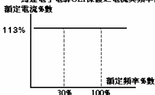
專用馬達OL1保護曲線 OL = 113% 起點,123%/分鐘
