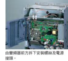
由變頻器前方拆下安裝螺絲及電源接頭。
